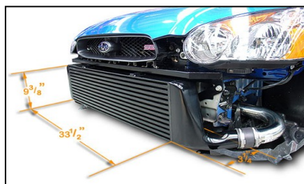
Figura 7. Intercooler ar-ar com resfriamento evaporativo proposto para o sistema
