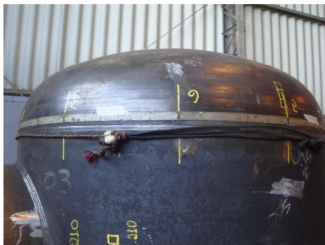
Figura 6 - Solda em tampa ensaiada. As linhas amarelas verticais indicam aonde será colocado o filme radiográfico
