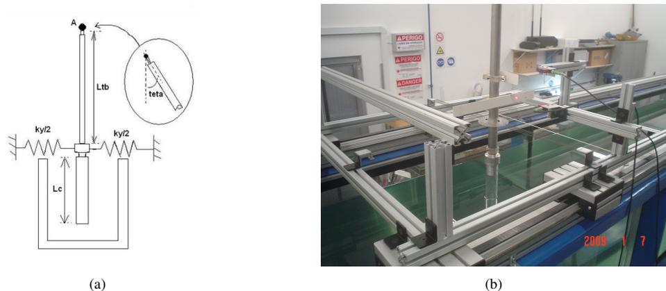
Figura 1. Base elástica pendular desenvolvida (a) representação esquemática (b) base implementada
