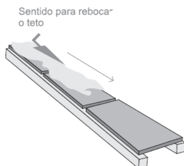
Figura 46 - Sentido para rebocar o teto FONTE: Brito (2002)
