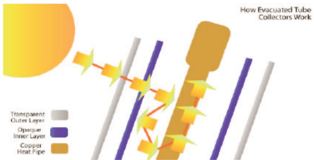
Figura 18: Funcionamento de uma bomba de calor de tubo a vácuo (Fonte: Sunmaxx)
