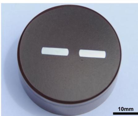
Figura 15: Amostra comprimida com 60 tonf sem lubrificação
