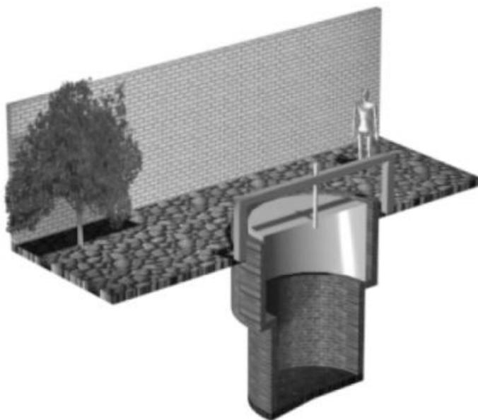
Figura 5 – Biodigestor de Batelada (DEGANUTTI *et. al.*, 2002.)
