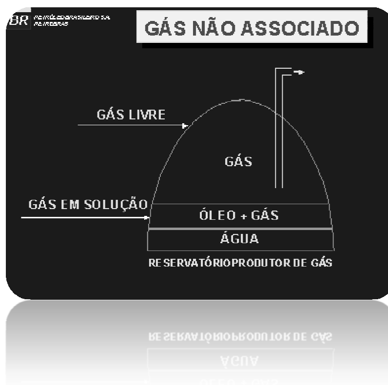
Figura 2 - Gás natural em sua forma não-associada (Petrobrás; 2003)
