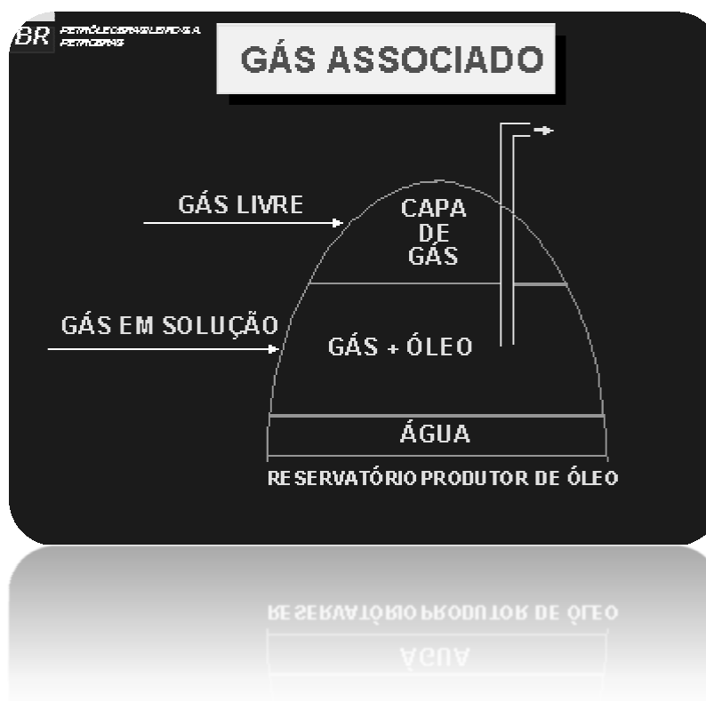
Figura 1 - Gás natural em sua forma associada (Petrobrás; 2003)
