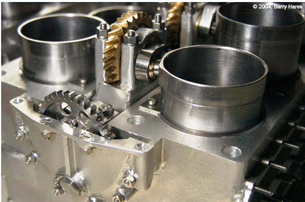
Figura 4: Mecanismo de funcionamento da válvula de luva.
