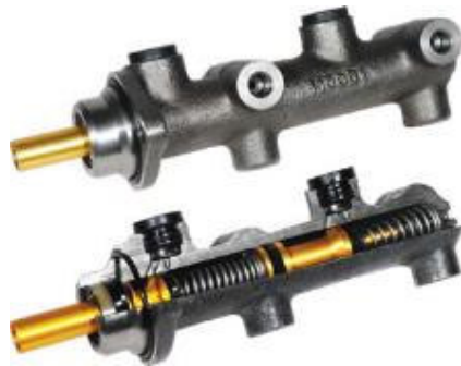
Figura 10. Cilindro mestre com corte 7
