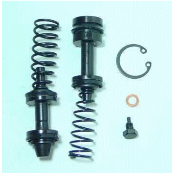
Figura 9. Pistões, molas e anél elástico 6
