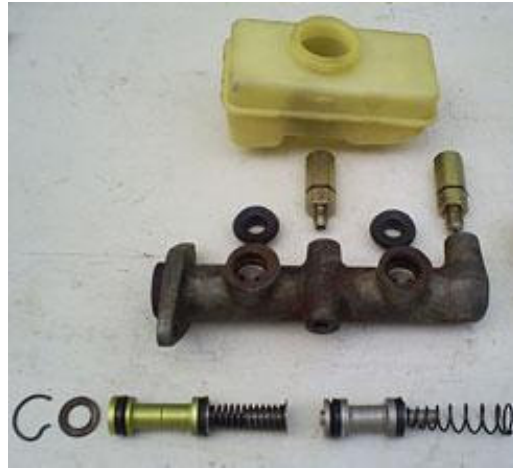
Figura 12. Cilindro desmontado após o uso 12
