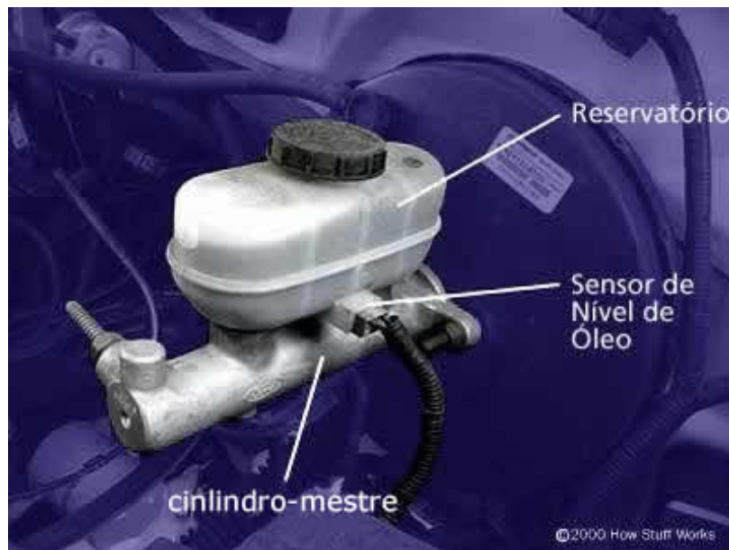
Figura 5. Posição do cilindro mestre 3
