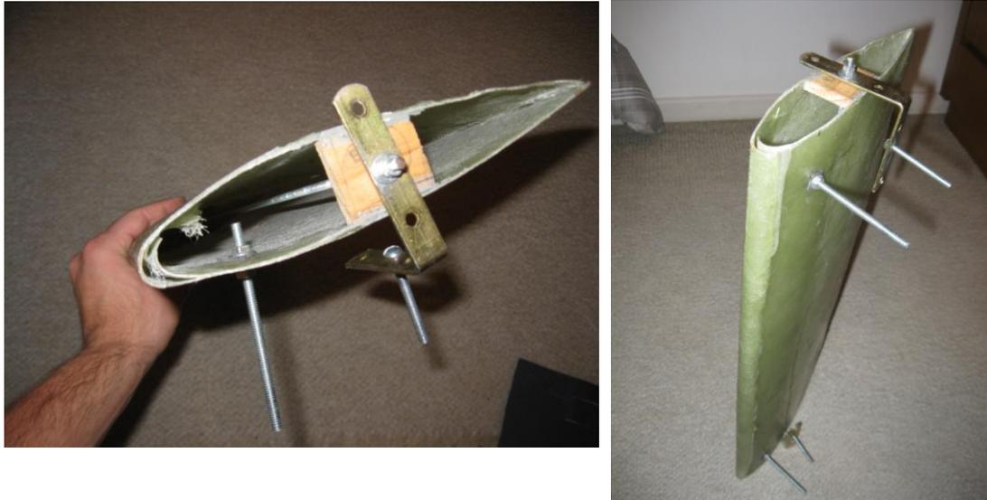
**Figuras 43 e 44: Detalhes da montagem final do fólio (para fixação nas rodas)**
