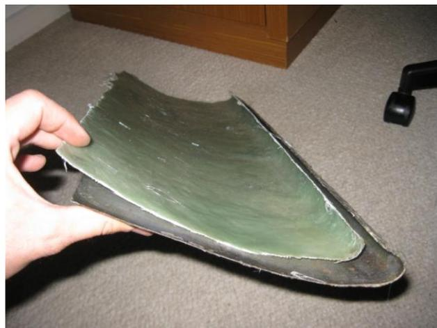
**Figura 42: Gabarito (chapa de aço) e o laminado (meio perfil do fólio)**
