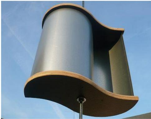
**Figura 18: Turbina Savonius**
