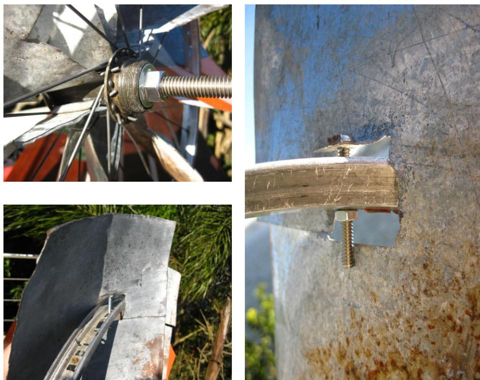
**Figura 41. Detalhes construtivos da fixação das pás da turbina de rotor do tipo H (fólio) nos aros das rodas.**
