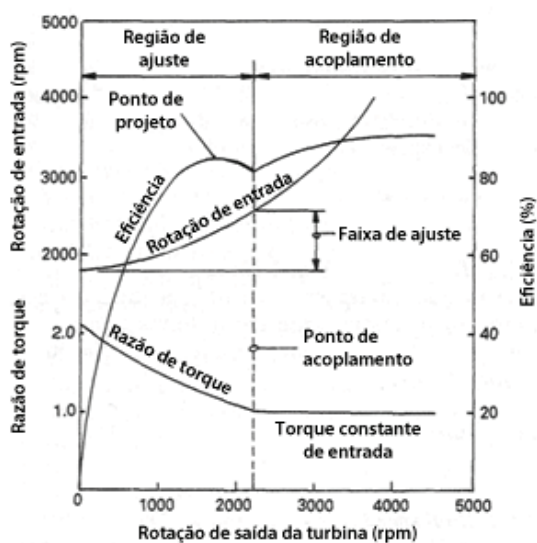
Fig. 5. Curvas características de um conversor de torque. Adaptado de Heisler (2002)
