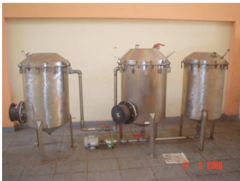
Figura 30 – Montagem parcial da planta piloto de produção de biodiesel.
