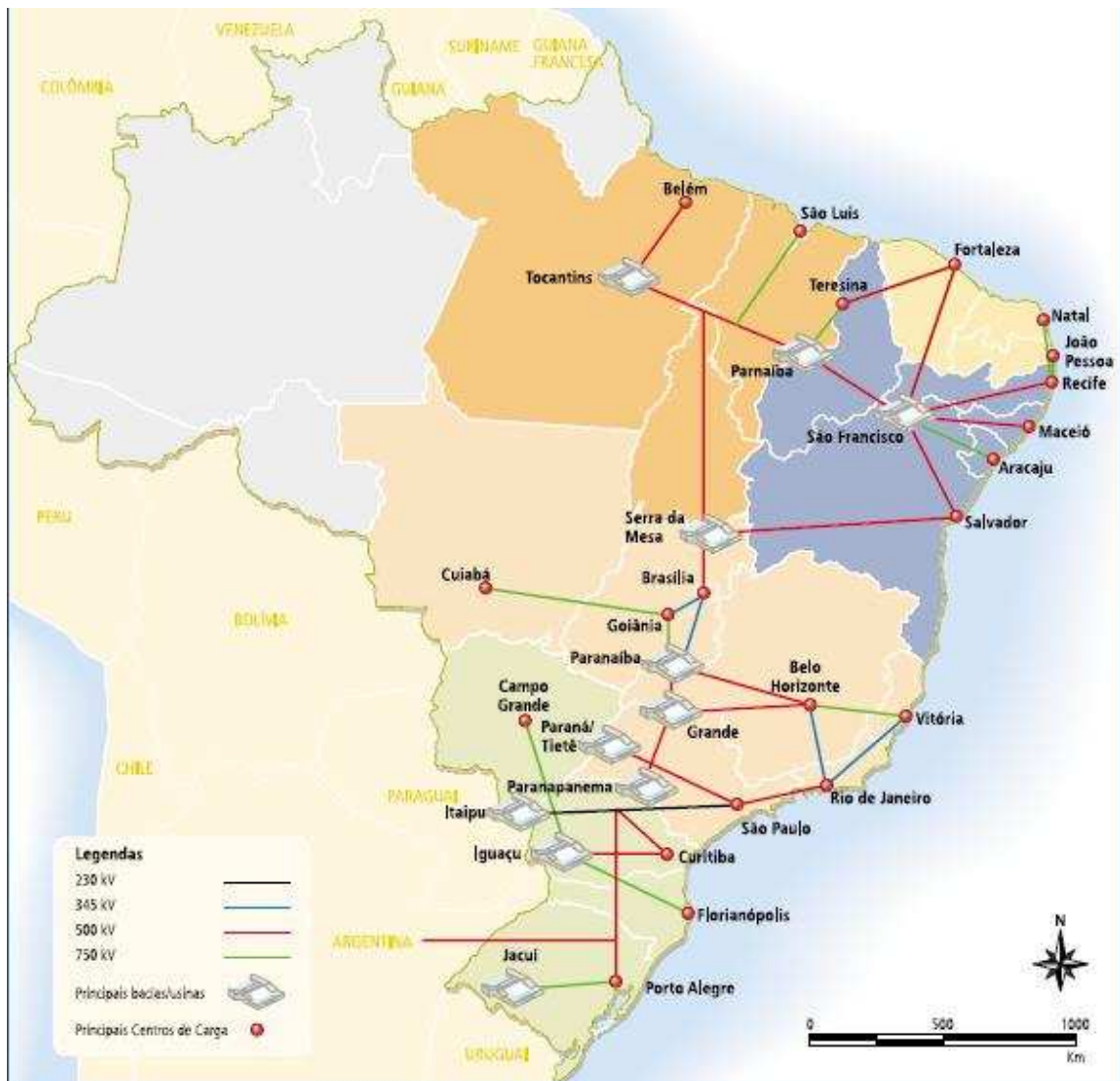
Figura 2 – Representação esquemática do Sistema Integrado nacional [2]
