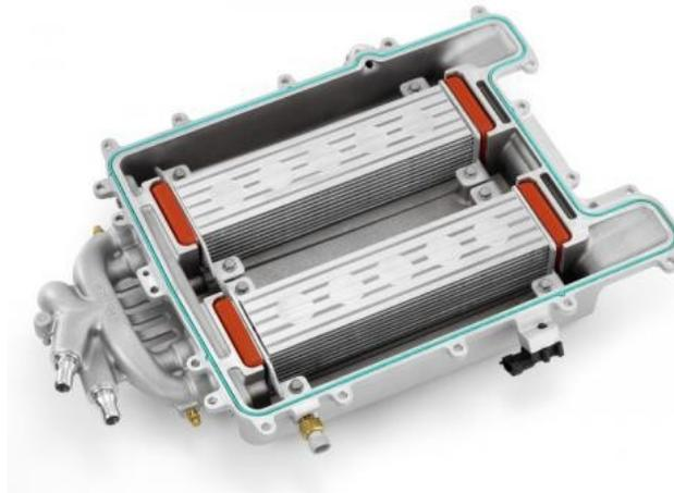
**Figura 12. Intercooler ar-água**
