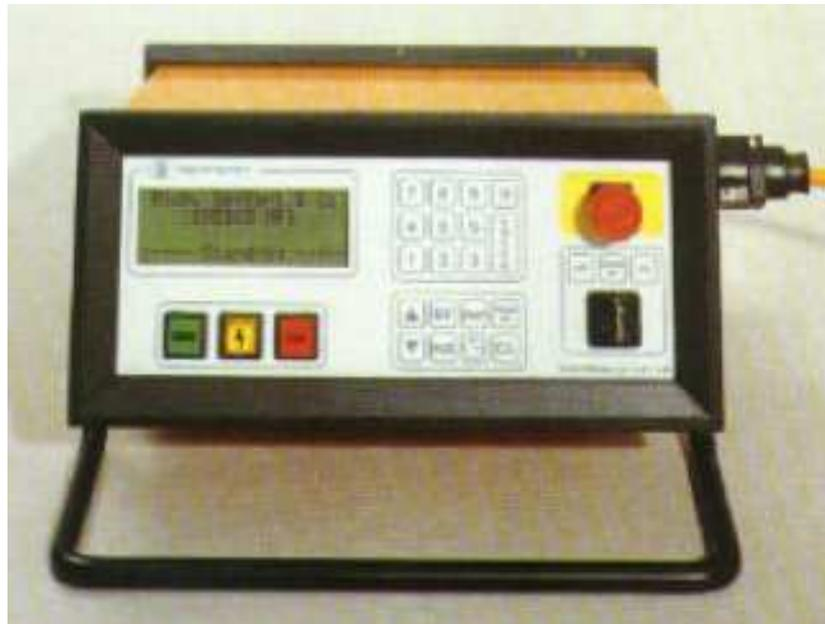
**Figura 25 - Painel de Controle de um Gerador de Raios-X**
