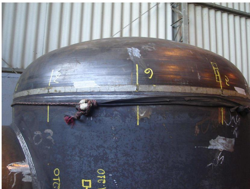
**Figura 44 - Solda em tampa ensaiada. As linhas amarelas verticais indicam aonde será colocado o filme radiográfico**
