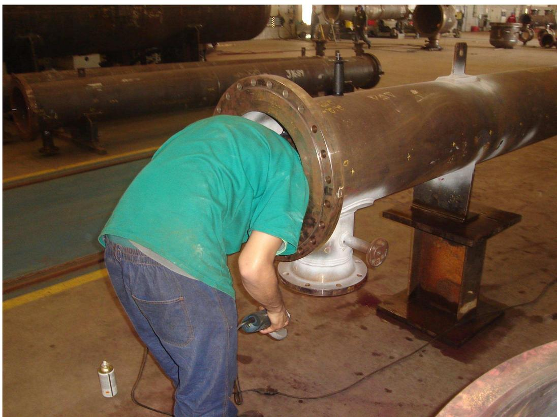
**Figura 41 - Inspetor realizando o EN por Líquido Penetrante**
