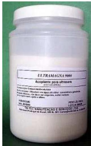
**Figura 19 - Gel Acoplante. Neste caso, Metilcelulose. Ideal para materiais não ferrosos.**
