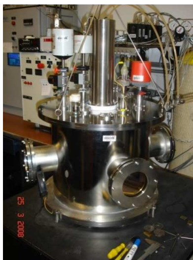
Figura 32. Câmara utilizada na deposição dos filmes
