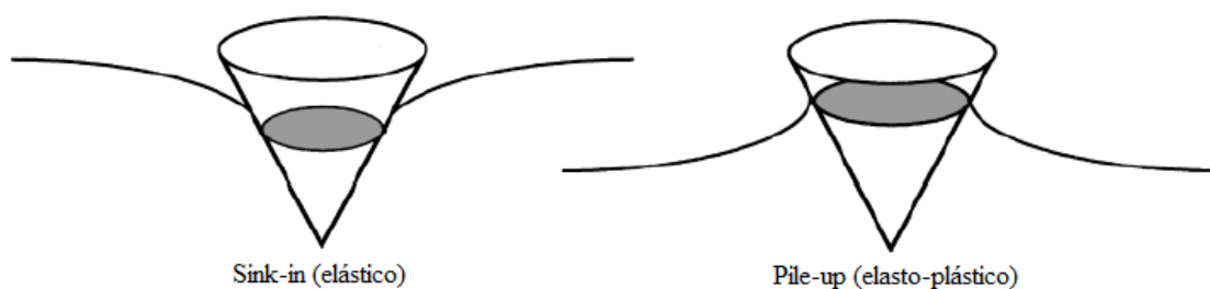
Figura 13. Fenômeno de sink-in e pile-up (21)
