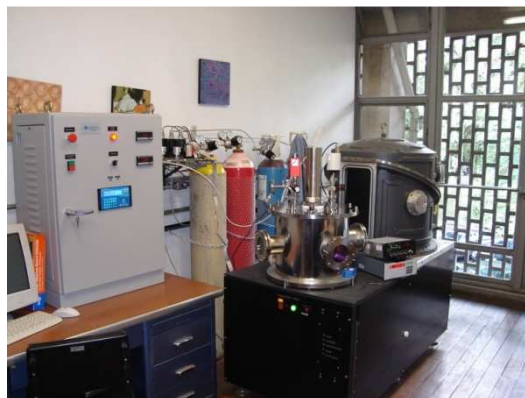
Figura 31. Aparato utilizado na deposição dos filmes
