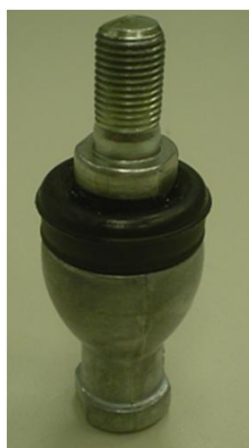
Figura 5.4: Junta esférica utilizada na base elástica pendular
