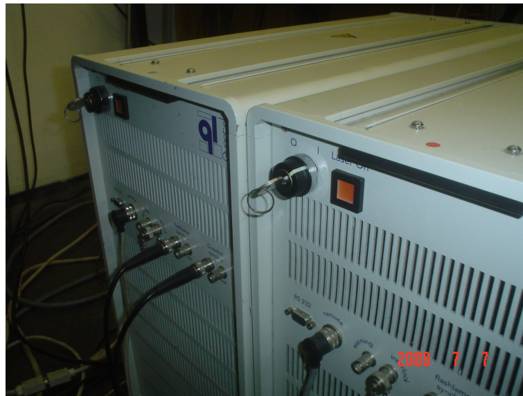
Figura 6.2: Chaves para ligar o sistema de refrigeração dos capacitores do laser
