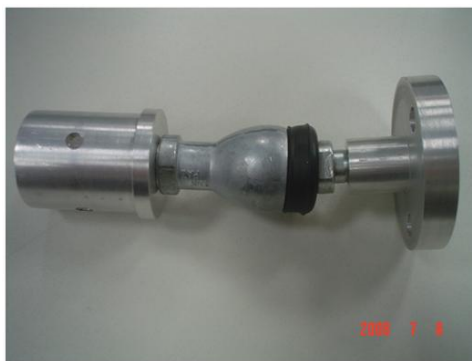
Figura 5.10: Conjunto responsável pela articulação do tubo de titânio
