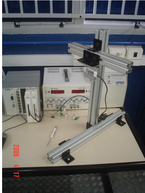
Figura 7.2: Montagem experimental para calibração da célula de carga
