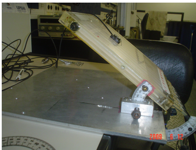
Figura 7.14: Montagem experimental para calibração do acelerômetro
