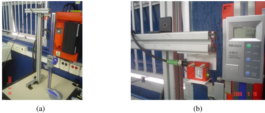
Figura 7.9: Detalhes da montagem experimental utilizada no levantamento da curva de calibração do sensor óptico
