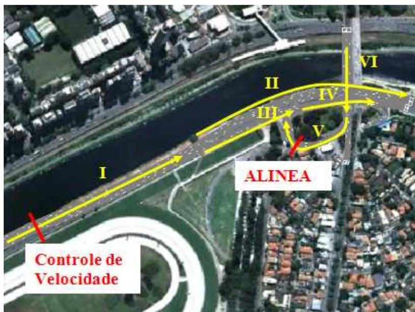
Figura 1: Imagem de uma simulação com indicação dos trechos estudados e dos trechos onde atuam os controles
