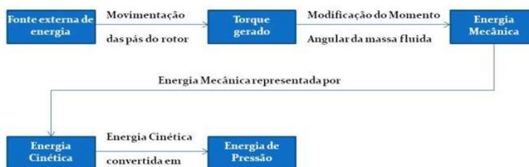
Figura 2. Esquema representativo do funcionamento básico de uma bomba.
