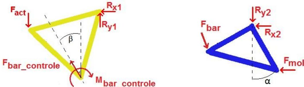
Figura 19. Diagrama de força em equilíbrio estático do braço da suspensão (esquerda) e do balancim (direita).
