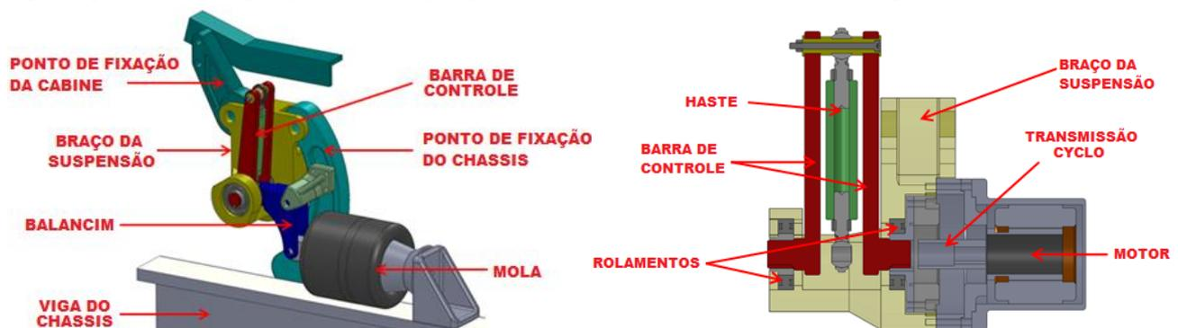
Figura 17. Configuração para o caminhão modelo XF (esquerda) e corte transversal mostrando a disposição dos componentes (direita).
