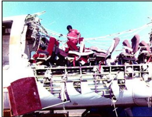
Figura 2. Fuselagem do vôo 243 da Aloha Airlines (AirDisaster.com)
