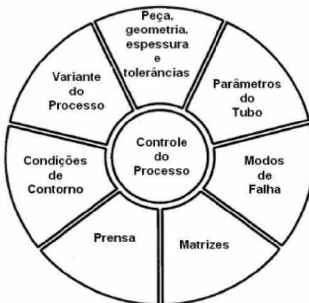
Figura 1.2.5. Parâmetros que influenciam o controle do processo (DOHMANN; HARTL, 1996)
