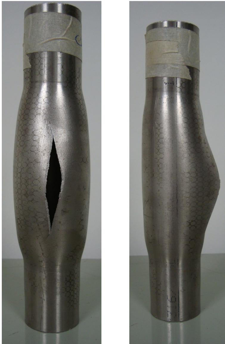
Figura 6.1.4. Tubo levado até o nível de pressão de ruptura (63 MPa).
