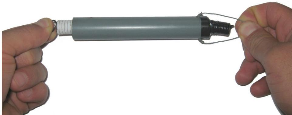
Figura 8. Dinamômetro
