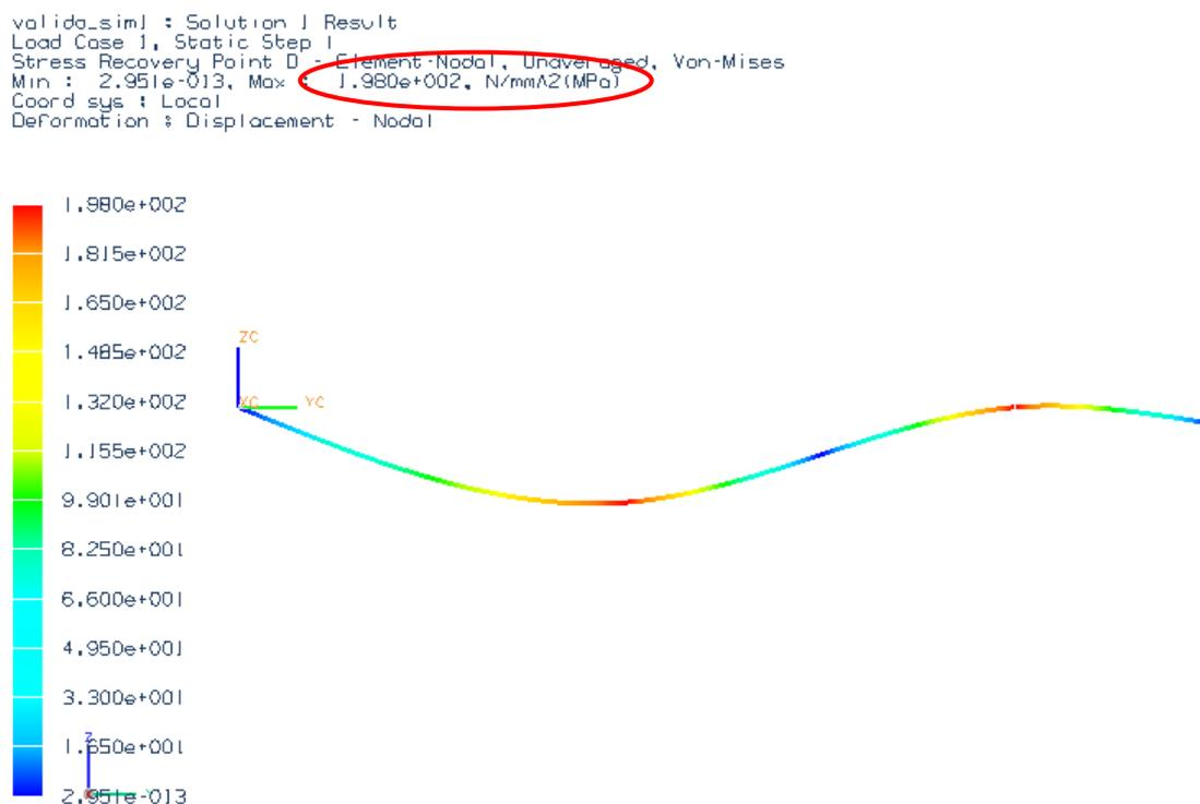
**Figura 25. Tensões numa viga similar à da Figura 23 simulada computacionalmente**
