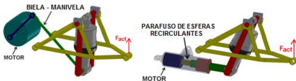
Fig. 5.8 - Diferentes configurações para a posição do motor no mecanismo arco-circular. (esquerda) biela-manivela. (direita) por parafuso de potência.
