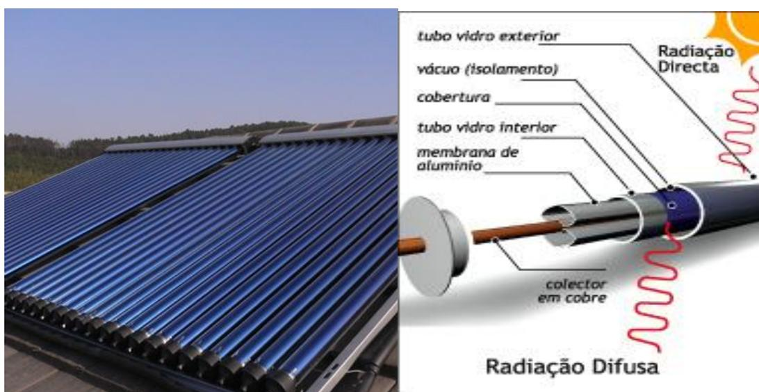
**Figura 4.7.3** – Coletor solar com tubos a vácuo e seus componentes (Fonte: MARLA).
