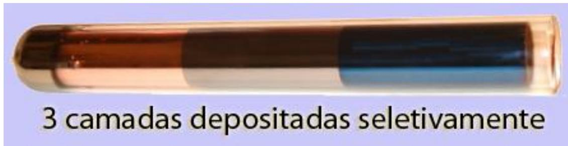
**Figura 4.7.10** – Tubo a vácuo com as três camadas depositadas na parede de vidro (Fonte: MARLA).
