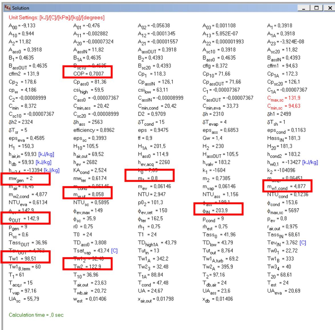
**Figura 7.1.7** – Resultados do ciclo para o período de alta carga térmica (destaque para as vazões, potências e temperaturas de interesse, marcadas com retângulos vermelhos).
