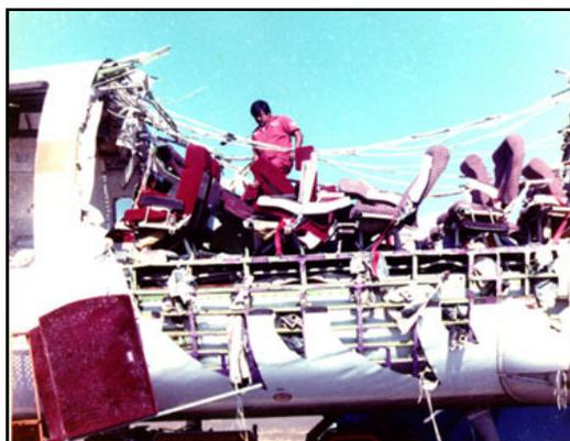
**Fig. 2 Fuselagem do vôo 243 da Aloha Airlines (AirDisaster.com)**
