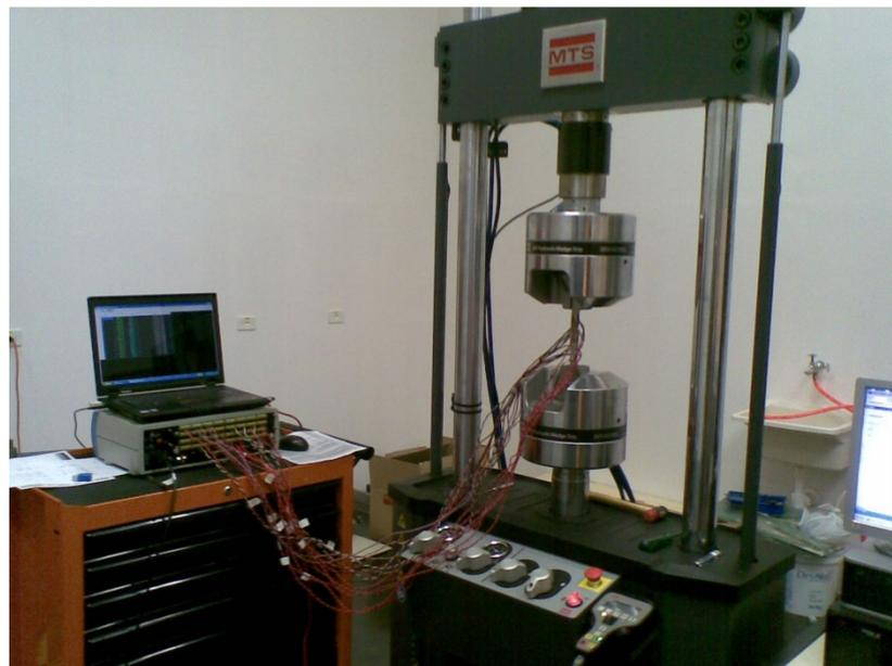
**Fig. 37** Extensômetros conectados aos canais.
