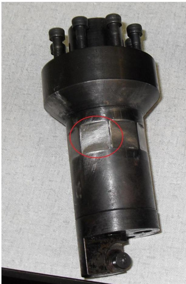
Figura 25 - Porta ferramenta com célula para extensômetro em destaque.
