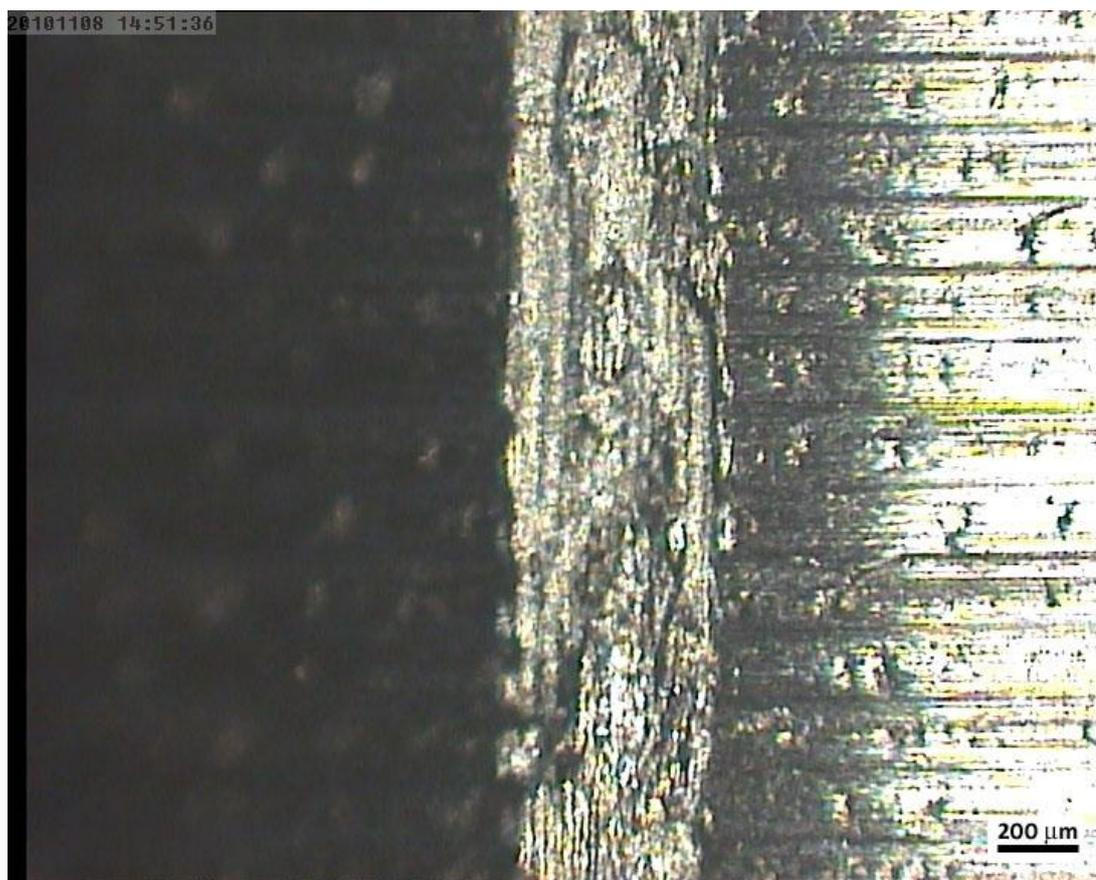
Figura 64 - Parte intermediária da ferramenta na região do quinto ensaio.
