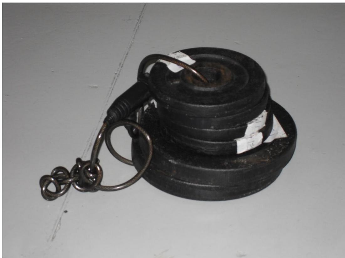
**Figura 44 - Alteres para calibração.**
