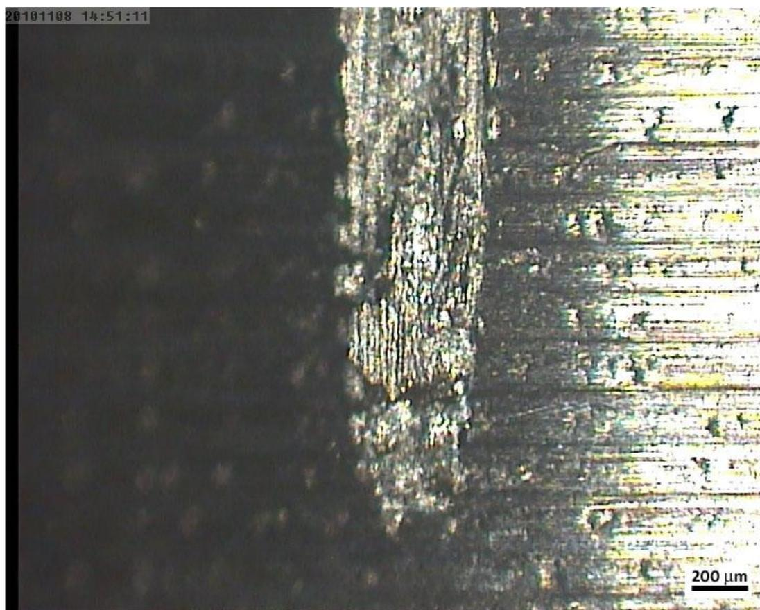
Figura 63 - Parte superior da ferramenta na região do quinto ensaio.
