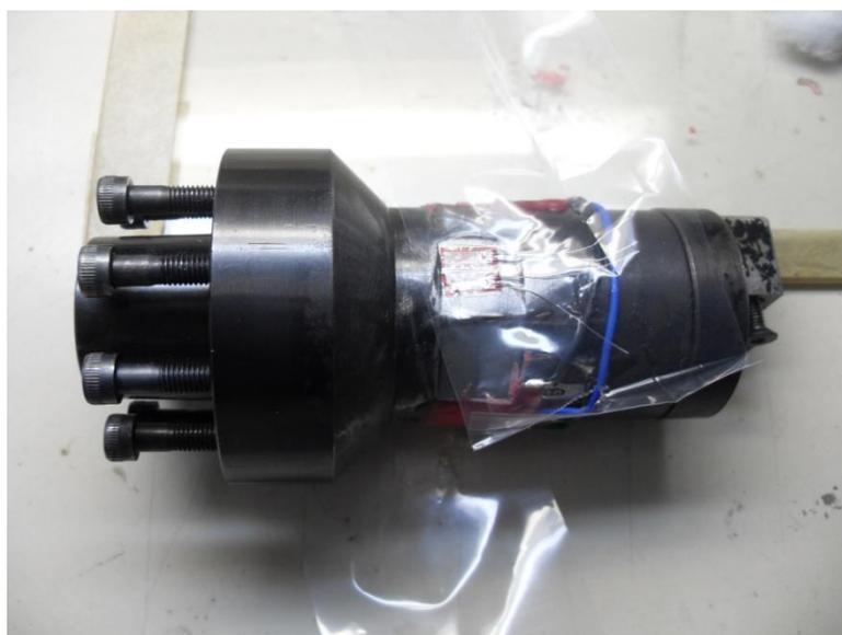
**Figura 33 - Extensômetro coberto com a folha de teflon.**
