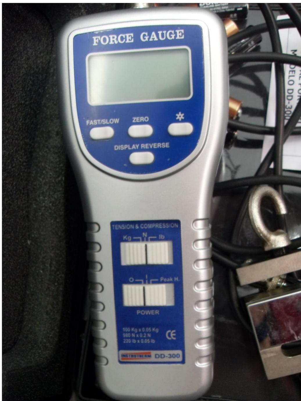
Figura 45 - Dinamômetro Instrutherm modelo DD-300.
