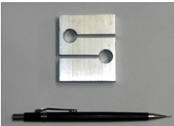
Figura 11 – Bloco da célula de carga final.
