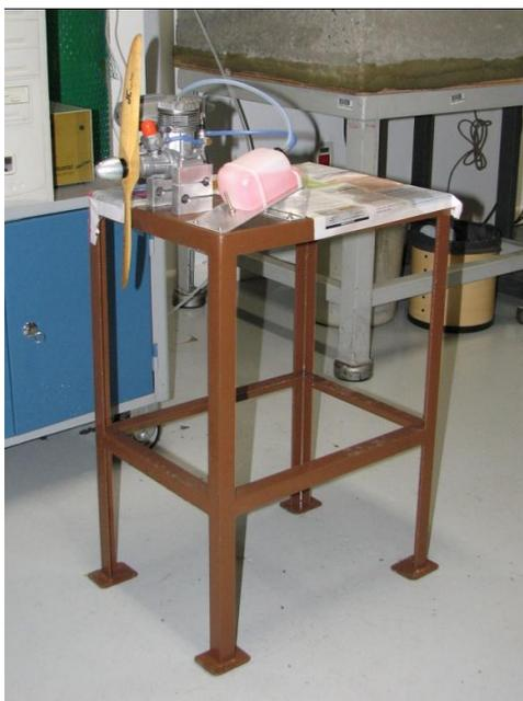
Figura 17 – A bancada montada na configuração de ensaio
