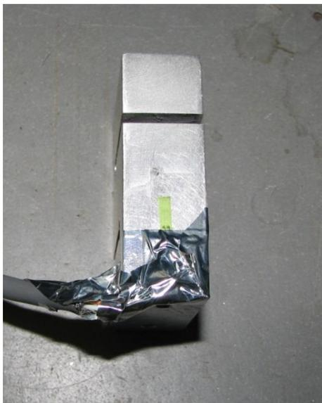
Figura 4 - Strain gage colado ao bloco de alumínio.
