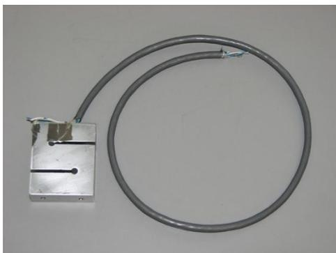
Figura 5 – 1ª célula de carga - bloco de alumínio + strain gage + cabo.
