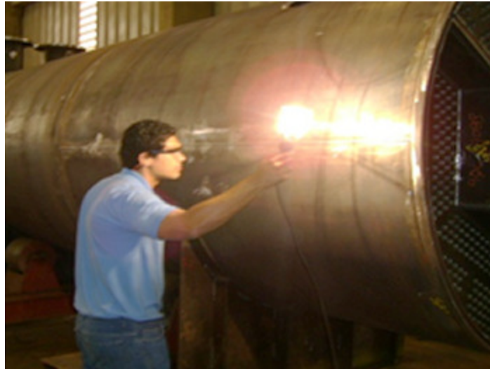
Figura 7 - Ensaio visual de solda com iluminação auxiliar
