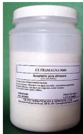
Figura 28 - Metilcelulose, acoplante ideal para materiais não-ferrosos
