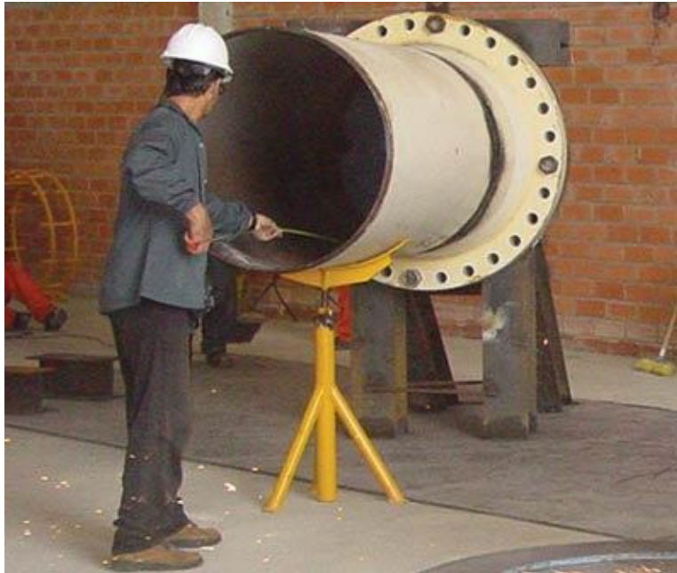
Figura 47 - Inspeção dimensional por trena
