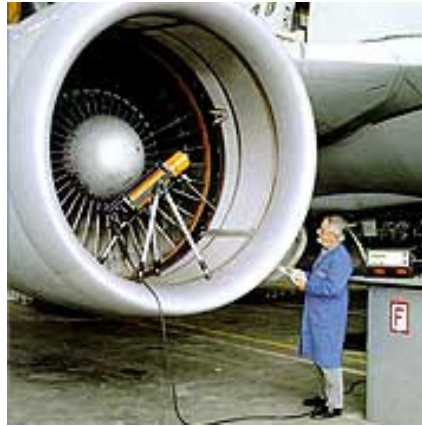
Figura 38 - Radiologia industrial aplicada à aeronáutica
