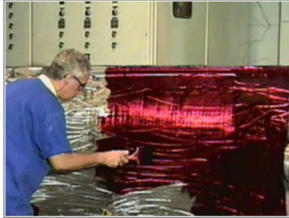
Figura 12 - Aplicação de líquido penetrante por pincel
