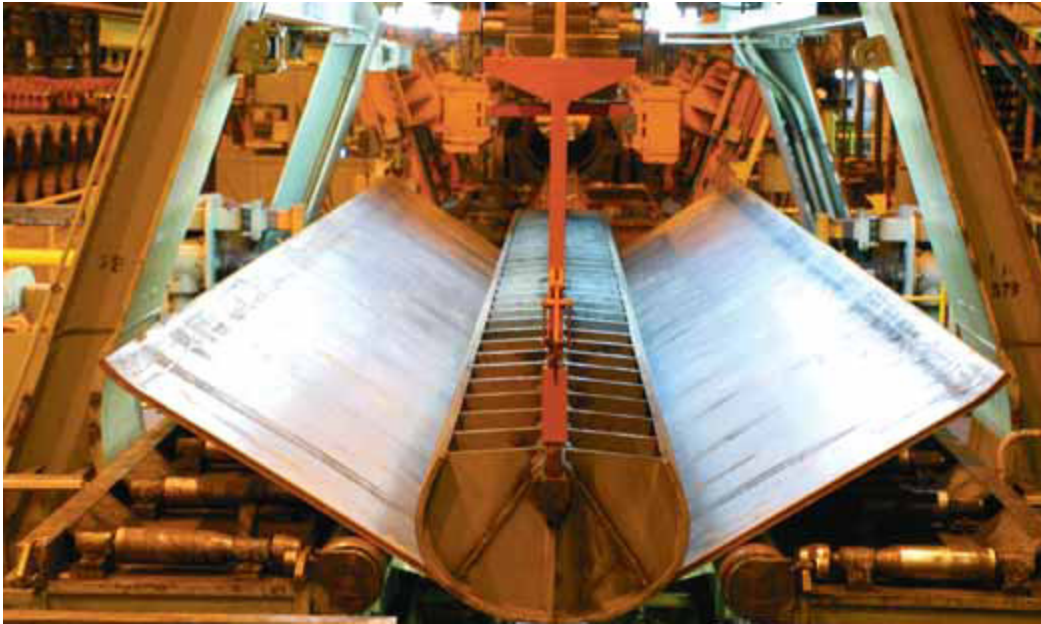
Figura 5 – Etapa de conformação do método SAW – Formação U-O-E (prensa U)
