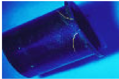
Figura 9 - Aplicação de líquido penetrante fluorescente (Tipo I)
