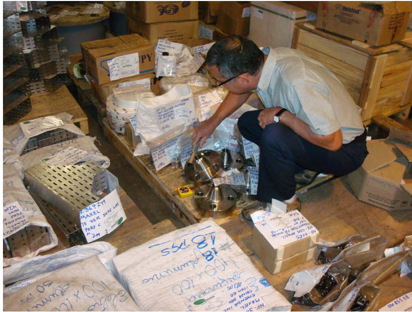
Figura 58 - Inspetor realizando ensaio dimensional
