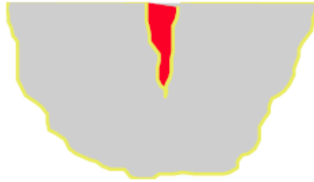
Figura 14 - Remoção do excesso de líquido penetrante
