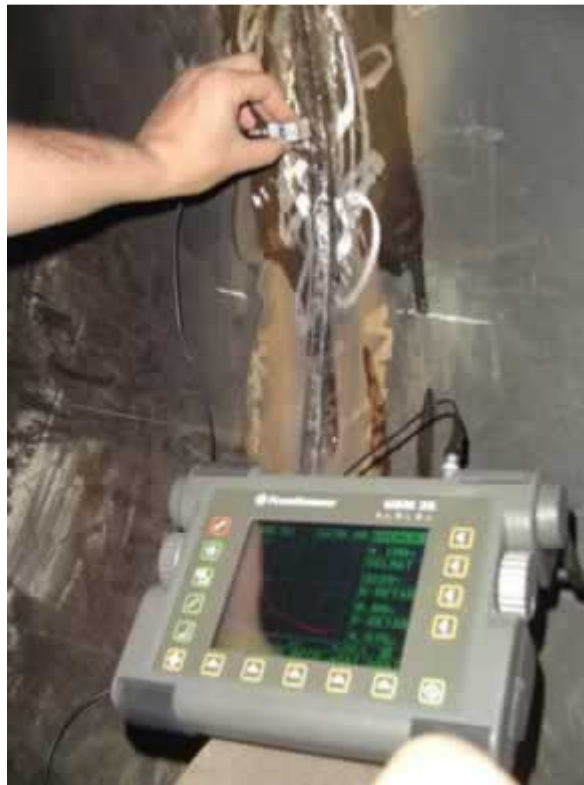
Figura 2 - Ensaio por ultra-som em uma viga de concreto
