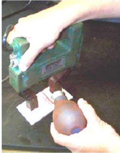
Figura 23 - Aplicação de partículas magnéticas via seca
