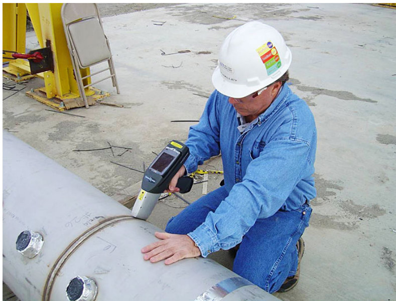
Figura 48 - Verificação por PMI
