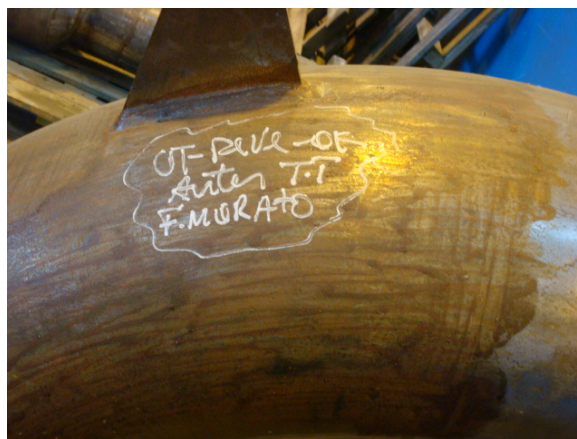
Figura 61 – Conexão submetida a US
