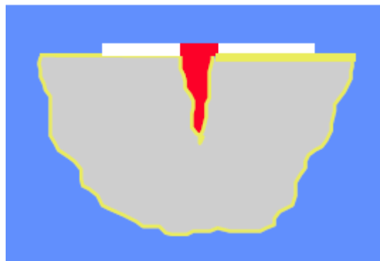
Figura 15 - Absorção do líquido penetrante pelo revelador
