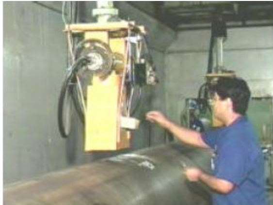
Figura 41 - Inspeção radiográfica de tubos
