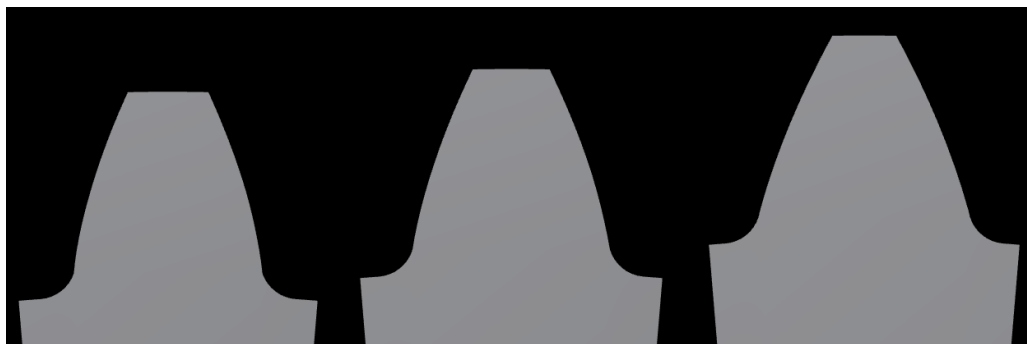
Figura 4 – Três perfis de dente de engrenagem obtidos com o programa. O primeiro tem uma correção de -0,2, o segundo não possui correção e o terceiro tem correção de +0,5
