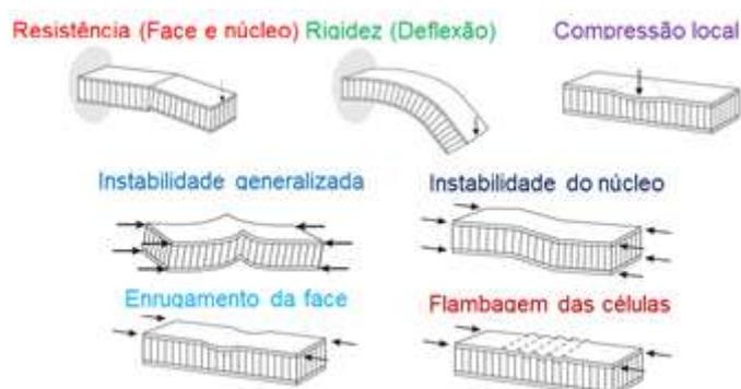
Figura 8 – modos de falha de uma construção sanduíche (Vinson, 1999).
