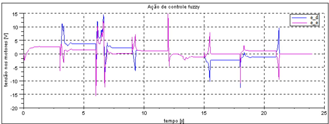
Figura 13. Gráfico das tensões nos motores no controle fuzzy
