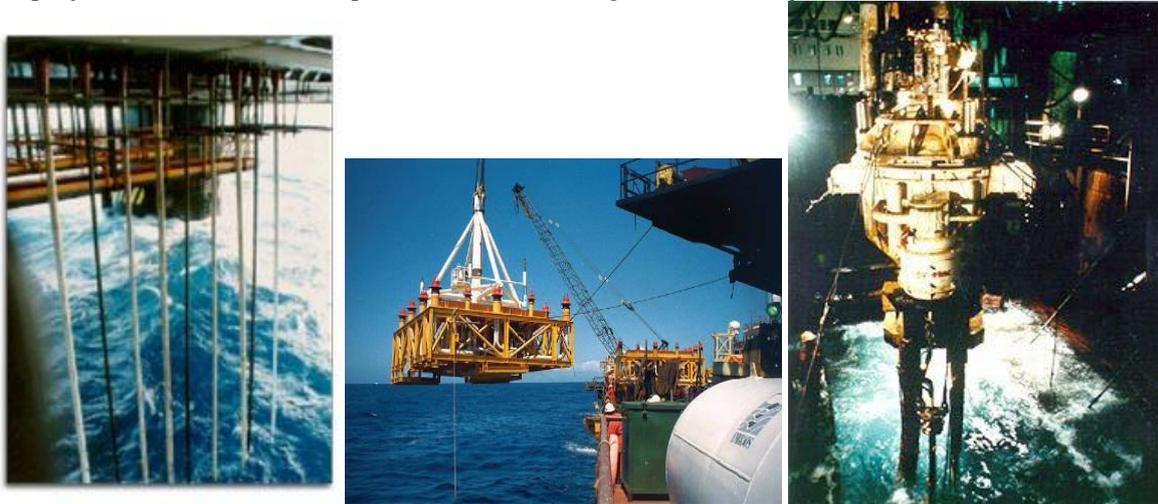
Figura 1. Estruturas marítimas. Da esquerda para direita: *Risers*, *Manifold* e *Árvore de Natal Molhada*.
