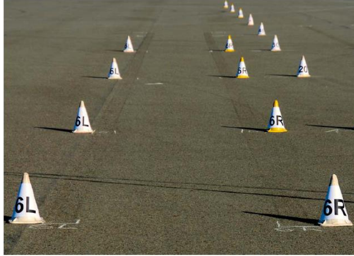
Figura 1 - Vestígios de frenagem produzidos por uma Mercedes-Benz CLK500 2005 equipada com freios ABS. Adaptado de (BAUMANN, et al., 2009)
