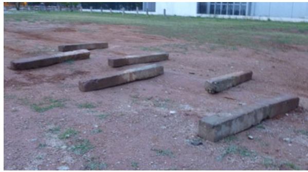
Figura 7 - Recriação do obstáculo de bump track na pista de testes.
