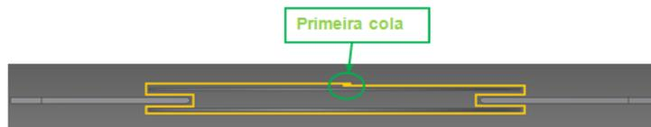
Figura 5 - Demonstração em corte da dobra nas placas de formato
