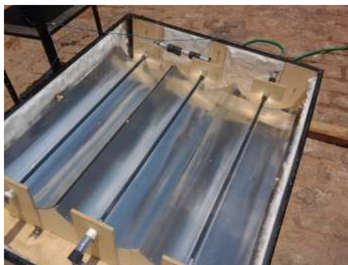
Figura 17. Coletor solar em funcionamento
