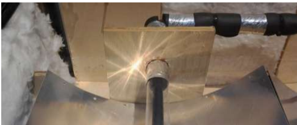
Figura 16. Concentração fora do foco, antes do ajuste da inclinação do coletor
