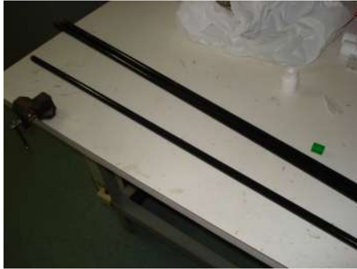
Figura 4. Tubos de cobre pintados de preto
