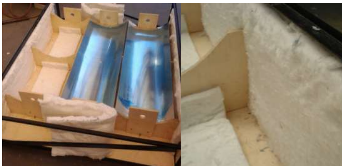
Figura 11. Isolamento térmico com lã de rocha
