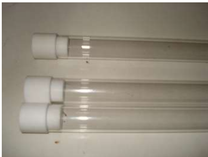
Figura 5. Tubos de vidro de diâmetro interno 28 mm
