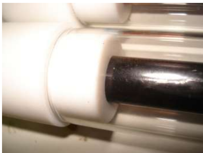
Figura 7. Ajuste do tubo de cobre e tubo de vidro
