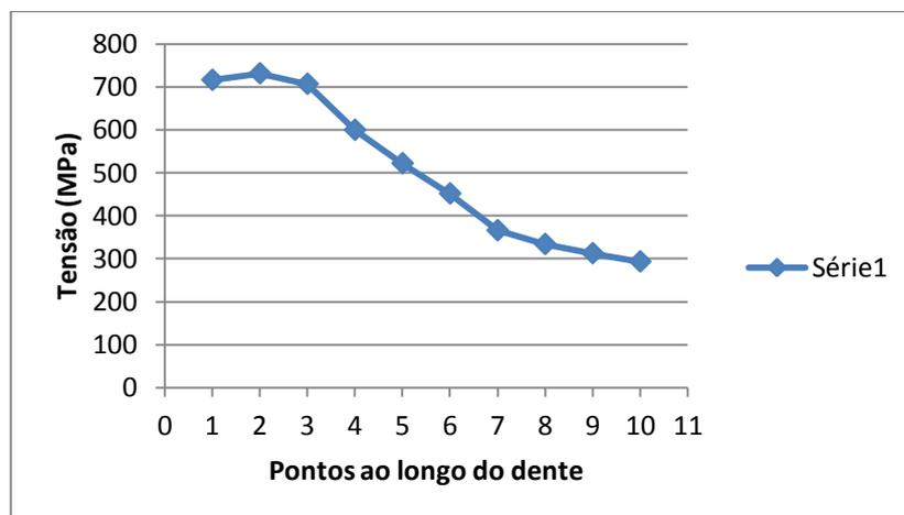
Figura 40 - Gráfico da Tabela 6 - Tensão de pé de dente no pinhão no ensaio 2
