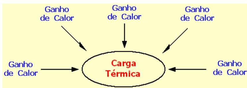
Figura 5.1 - Ganhos de calor e carga térmica na refrigeração.
