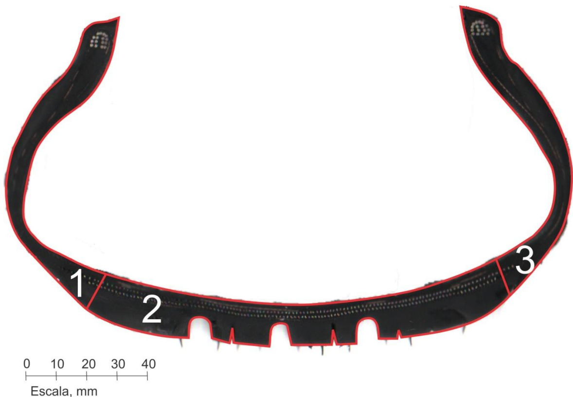
Figura A.1 – Seção transversal de um pneu 175/65 R14.
