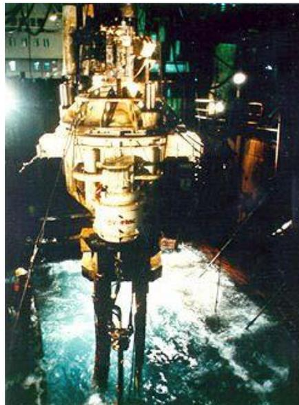
**Figura 3.** Árvore de natal molhada para 1000 metros de lâmina d'água. Reproduzido de [www.offshoreonline.com.br](http://www.offshoreonline.com.br).
