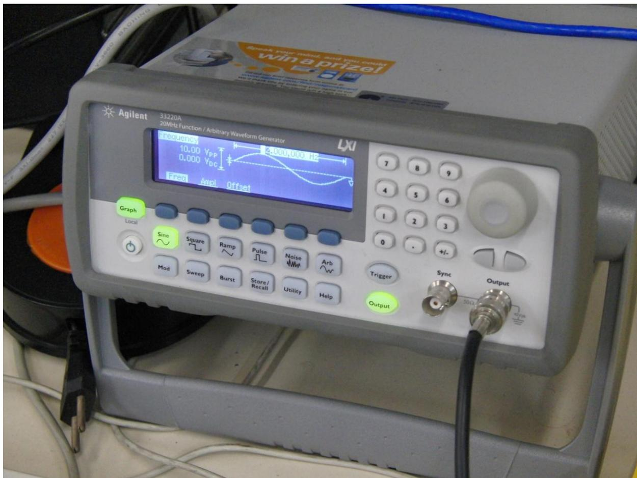
Figura 29. Gerador de funções produzindo uma onda senoidal.
