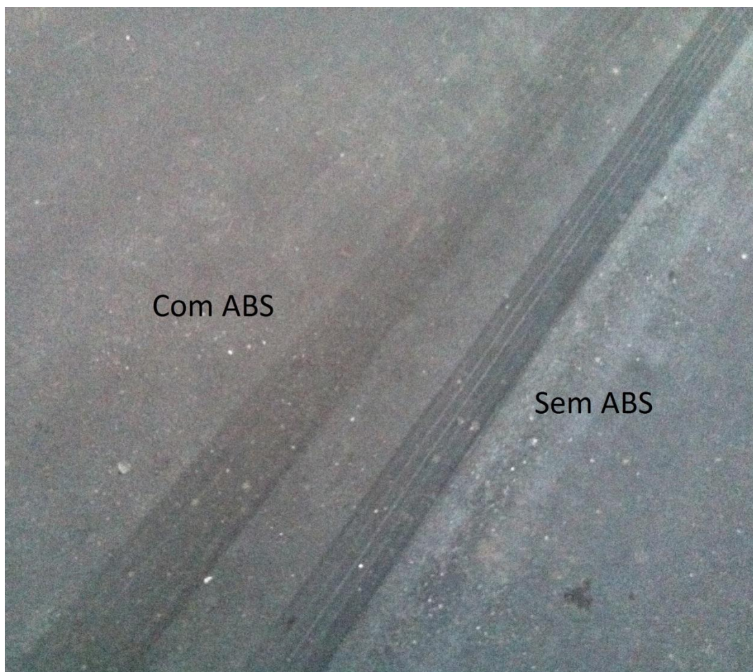
Figura 22 – Diferenças na intensidade das marcas com e sem ABS
