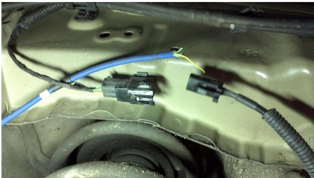
Figura 55 – Instrumentação dos sensores de velocidade das rodas dianteiras
