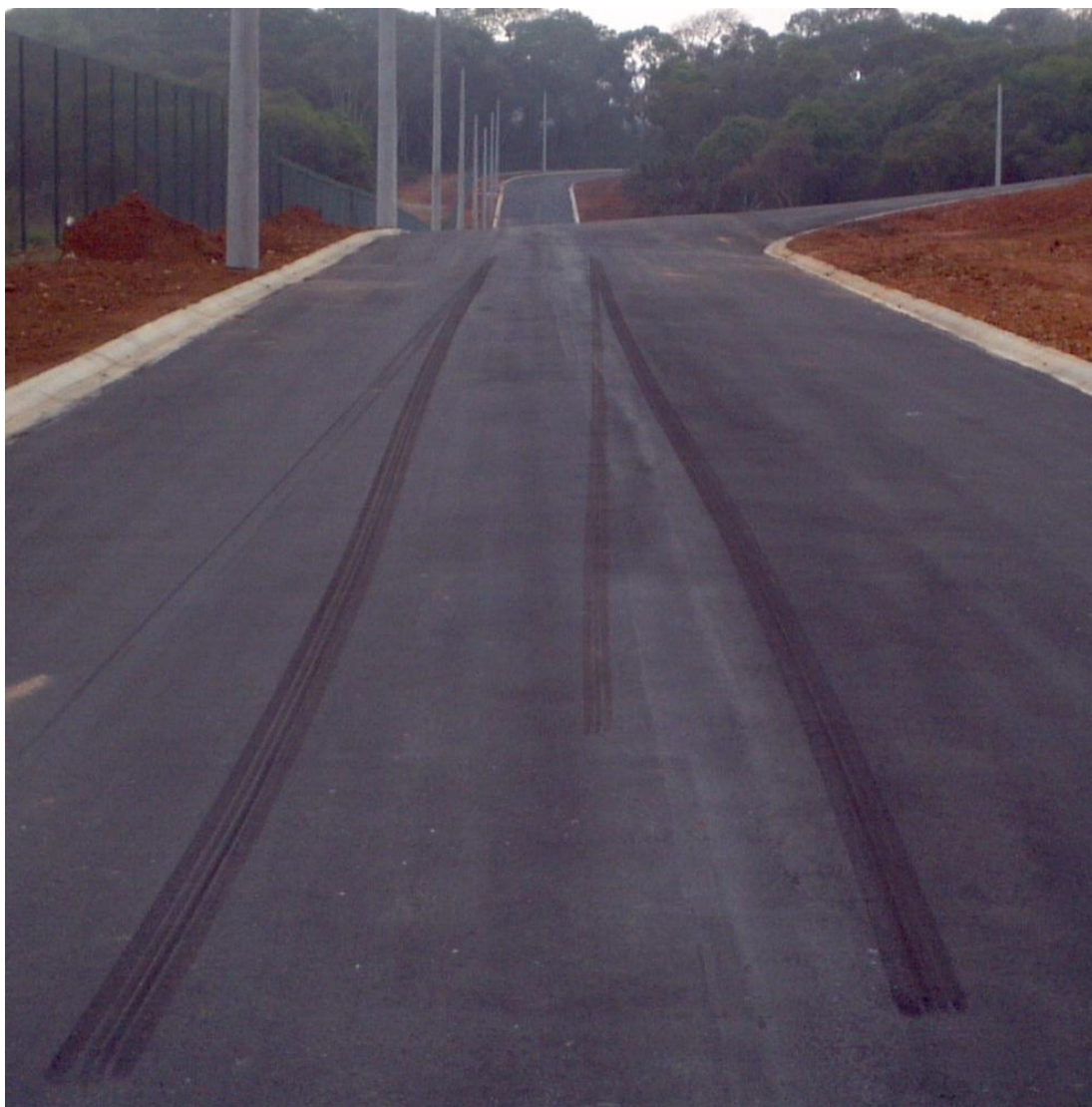
Figura 35 – Vestígios de Frenagem – Ensaio sem ABS
