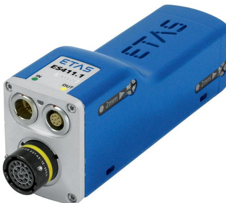
Figura 45 - Conversor A/D utilizado. Adaptado de (ETAS)
