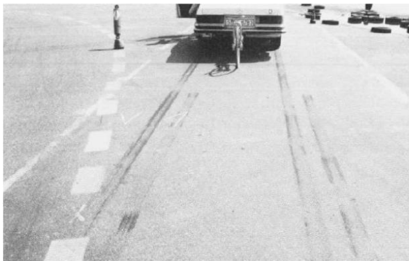
Figura 5 - Marcas de frenagem - veículo com ABS - década de 80 (BURKART, et al., 1980)
