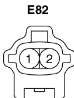
Figura 54 – Esquema conector de velocidade das rodas – Hyundai i30. Adaptado de (HMAService).
