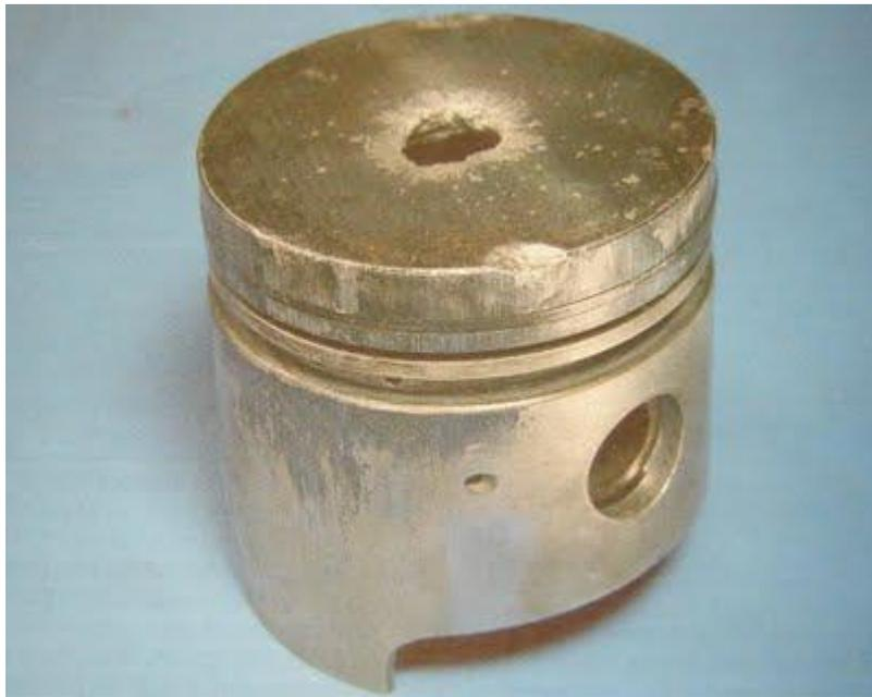
Figura 21: Pistão com furo devido a detonação.
