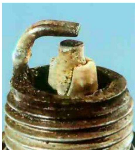
Figura 22: Vela danificada devido a detonação.
