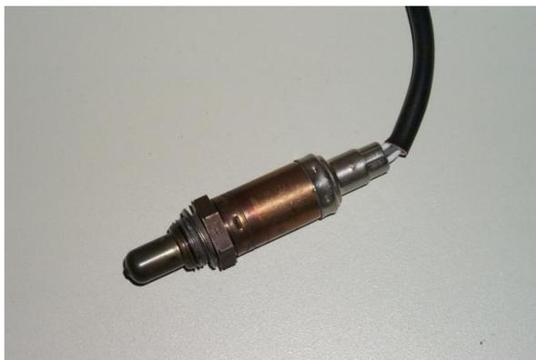
Figura 26: Detalhe externo da *Sonda Lambda*
