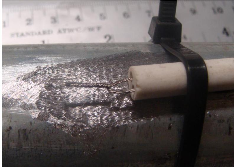
**Figura 23. Detalhe do enrolamento do termopar**
