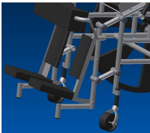
Figura 96: Apoio adicional para garantir estabilidade.
