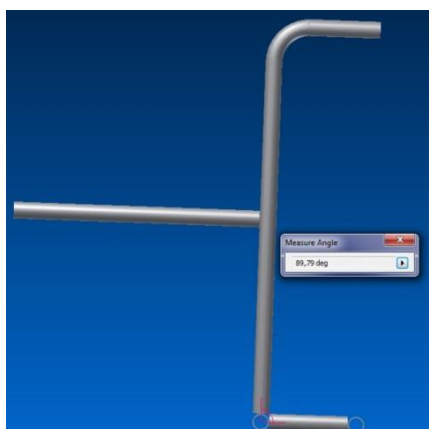
Figura 87: Ângulo de precisão exigido na barra 1.
