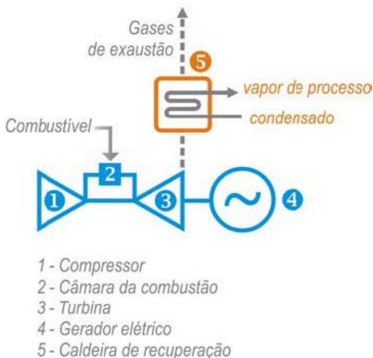
Figura 3.7 Ciclo de cogeração com turbina à gás.
