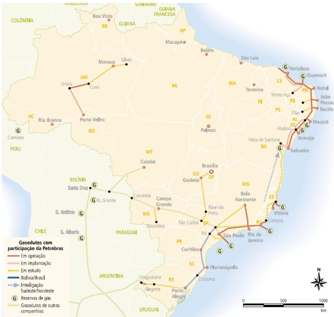
**Figura 7.2 Rede de distribuição de gás no Brasil. Retirado de (Aneel).**
