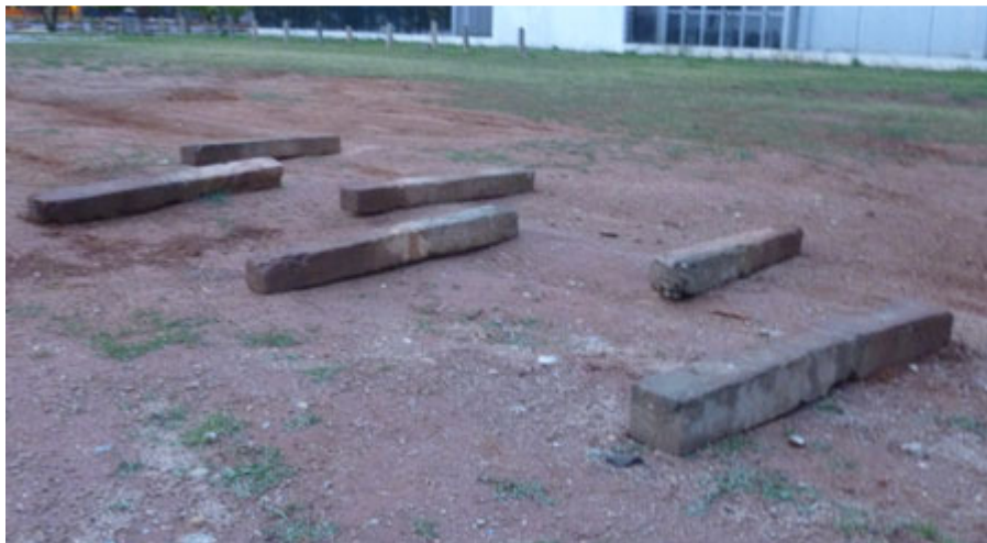
Figura 7-9 - Recriação do bump track na pista de testes.
