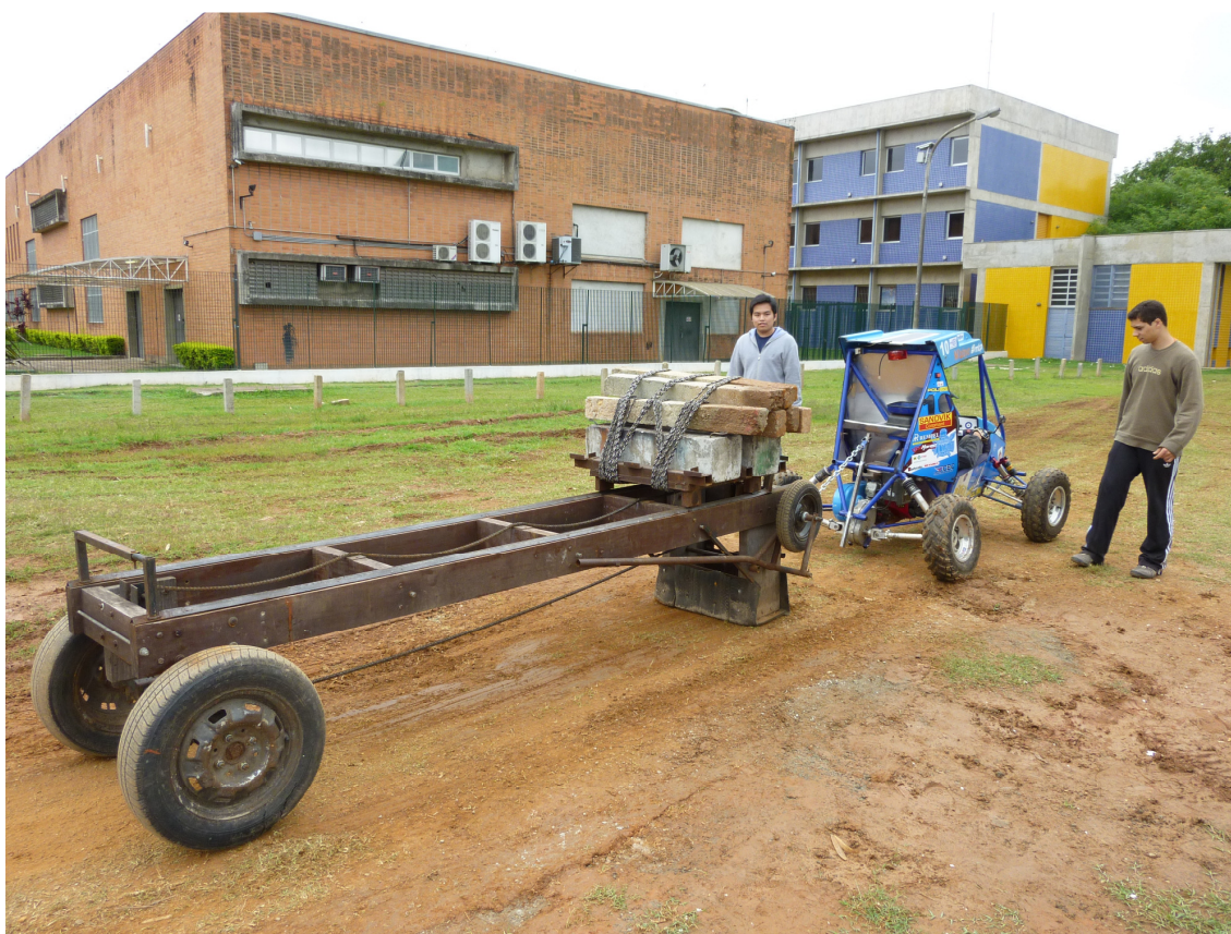
Figura 1-3 – Teste simulando a prova de tração com o protótipo 2010.
