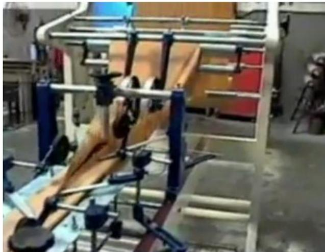
**Figura 12 - Sistema de dobra da MT-15 - AC Máquinas**
