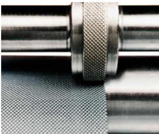
**Figura 9 - Processo de fabricação mecânico do rolo Anilox**
