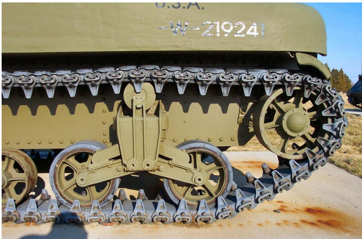
Figura 39: Protuberâncias na lagarta de um tanque M3A1 a mantém segura nas rodas de apoio.
