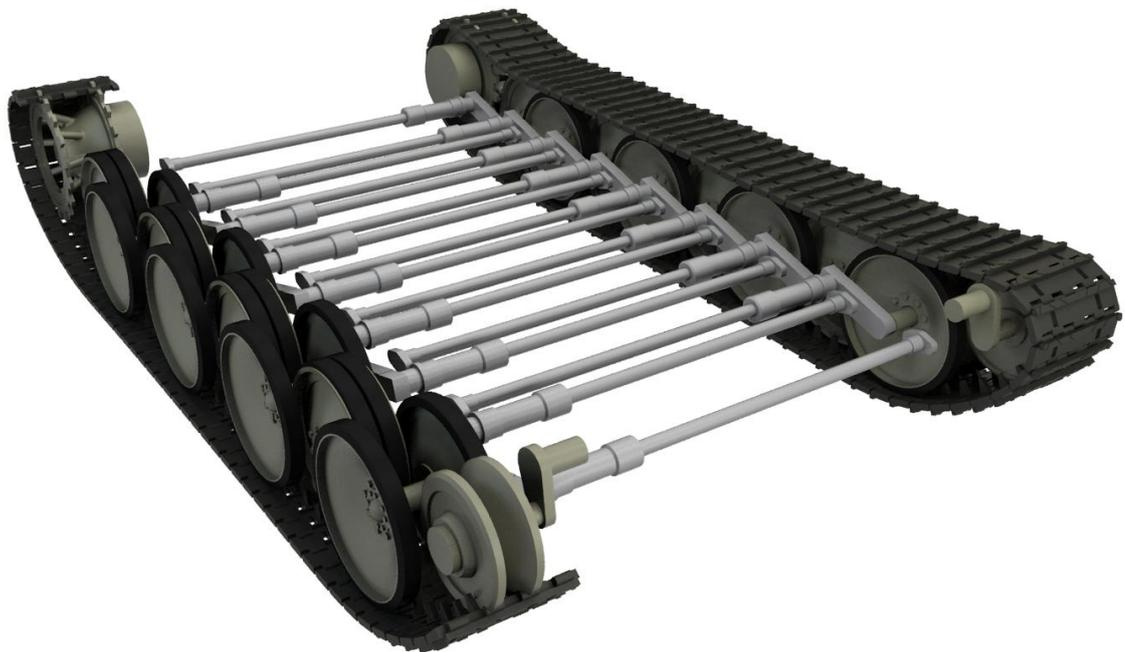
Figura 19: Esquema mostrando a disposição das rodas intercaladas e os braços de suspensão.
