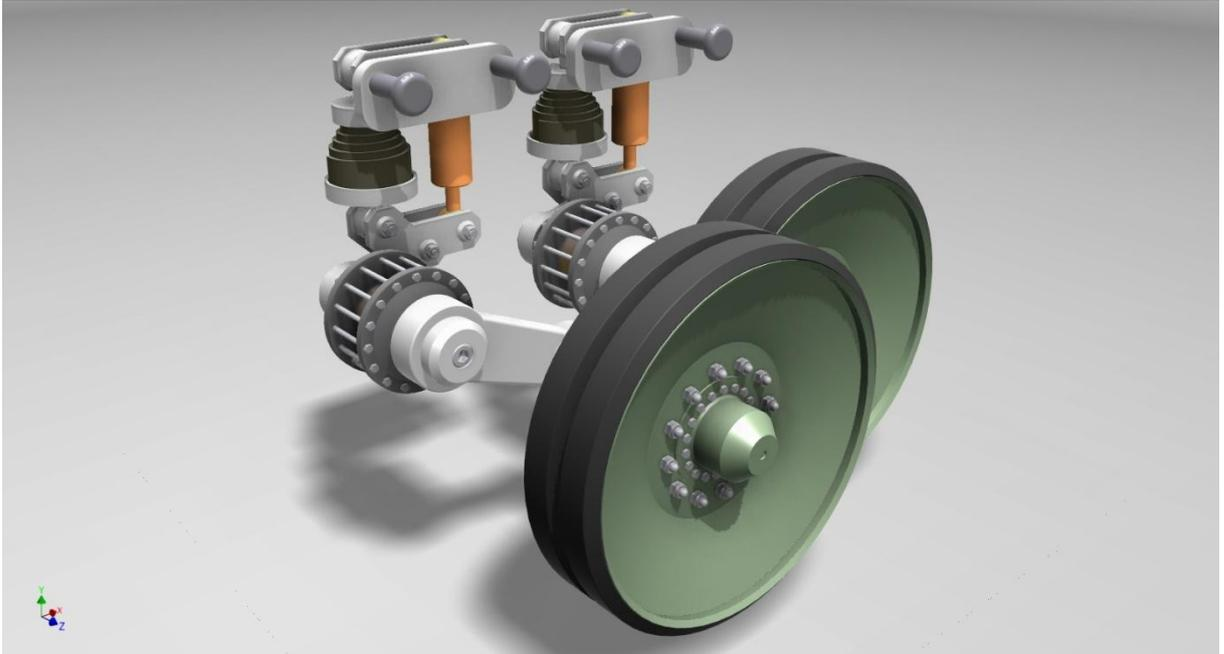
Figura 95: Desenho da suspensão e rodas de apoio. [Elaborado pelo autor]
