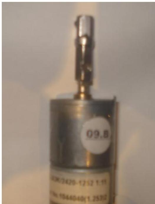
**Figura 69:** Peã de conexão entre o eixo do motor e as ferramentas, já encaixada no eixo do motor.
