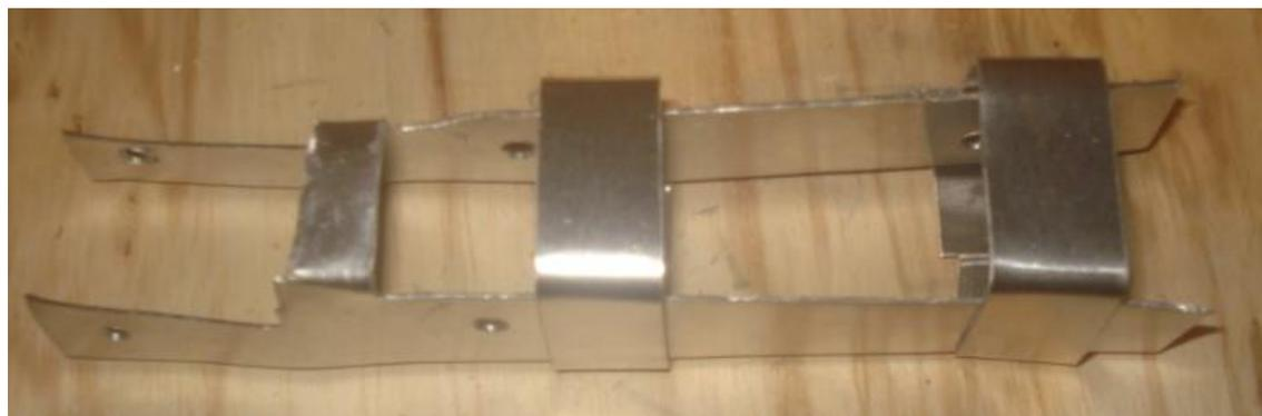
**Figura 80: Suporte com tiras de alumínio para fixação.**
