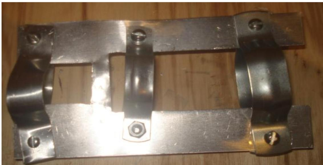
**Figura 77: Suporte com braçadeiras para motor e baterias.**
